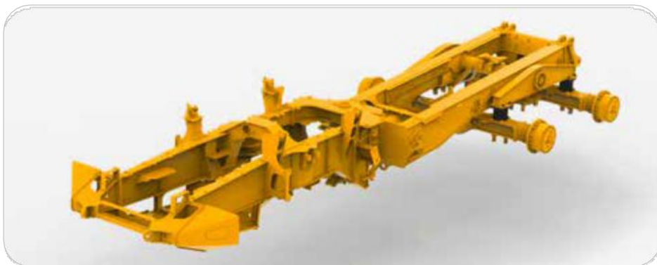
高強度鋼製シャーシは、過剰な重量を増やすことなく、高い強度と剛性を実現します。
